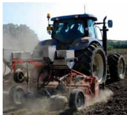
L'esecuzione degli interventi, inoltre, sfrutta un sistema di posizionamento automatico (GPS = Global Positioning System), che permette alla macchina di riconoscere sulla mappa il punto esatto in cui si trova e di differenziare conseguentemente l'operazione colturale a cui è preposta.
