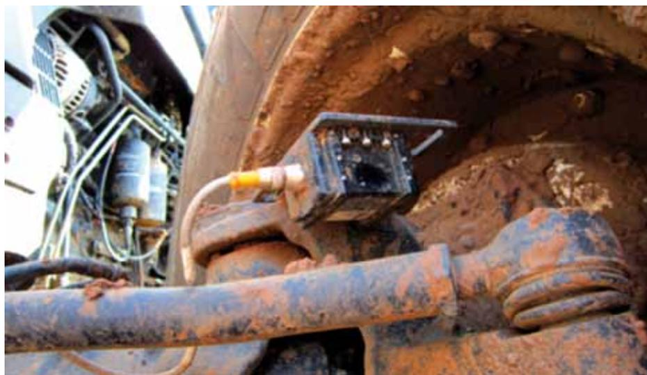
▲ Centralina di controllo idraulico del circuito guida
