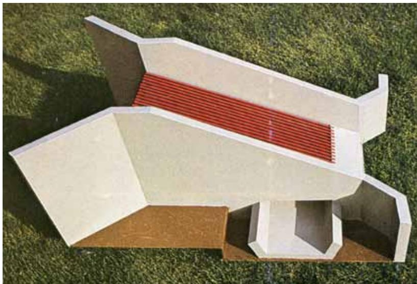
Fig. 9. Modello del dispositivo filtrante derivatore di cui alla figura 8.
