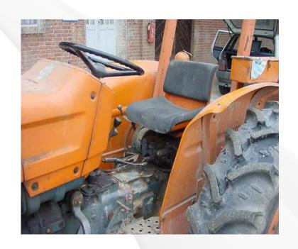
L'istallazione della sola cintura è prevista solo per i sedili fissi e per quelli regolabili omologati già predisposti per gli attacchi delle le cinture
