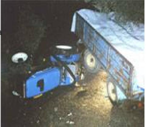
Descrizione infortunio: Per un'errata manovra di retromarcia su di una capezzagna sostenuta da un muro di sassi di 2 metri, nell'intento di trasportare delle ramaglie provenienti dal proprio fondo, l'agricoltore ha provocato il rovesciamento del mezzo, nella sottostante proprietà. E' rimasto schiacciato, in quanto non aveva sollevato l'arco di protezione.
