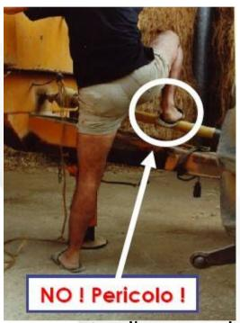
I tubi non devono essere utilizzati come punto d'appoggio per la salita o la discesa dalla macchina, sia con albero cardanico fermo sia, tanto meno, quando è in movimento.
