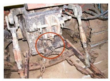
Può essere costituita da una protezione a scudo metallica posta superiormente e lateralmente alla presa di forza o da una guaina di materiale plastico.
