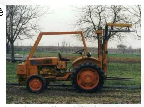
macchina nuova e diversa da quella originale, ad esempio modificandone la posizione di guida che diventa "reversibile"
