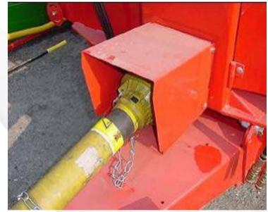
Non è permesso usare le catenelle per scopi differenti (sollevare l'albero cardanico o assicurarlo alla macchina operatrice quando non è collegato al trattore)
