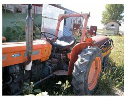
Le parti della macchina che raggiungono temperature elevate (collettore e terminale di scarico del motore) devono essere protette con griglie o reti metalliche poste ad adeguata distanza dalla fonte di calore in modo da evitare che si surriscaldino.
