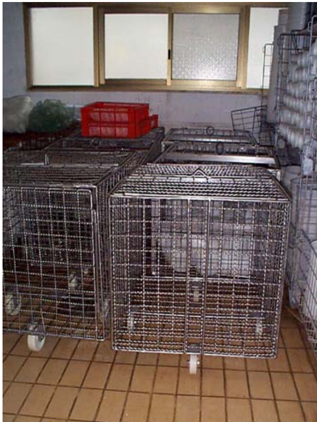
Cestelli dove introdurre le fustelle da lavare nella macchina.
